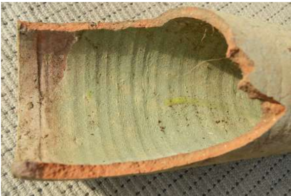
6. მოჭიქული კერამიკული მილი A ceramic pipe glazed from inside
