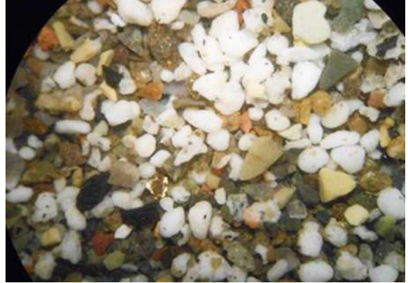
14. ყავლაშვილის ქ. #4: „ჭარბთაბაშირიანი ცემენტის“ გრანულომეტრული ნალექი 4 Kavlashvili street: granulometric sediments of "surplus" cement
