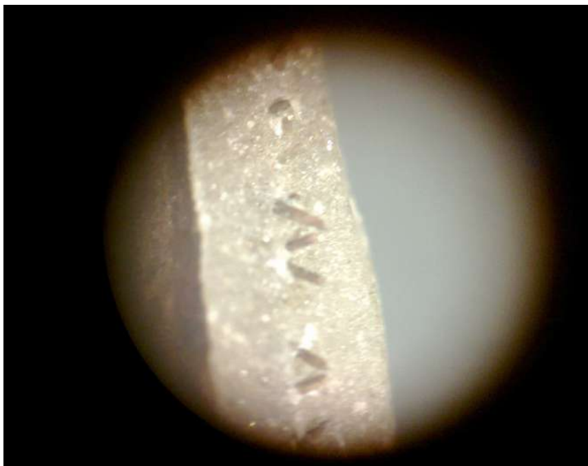
3. ბრინჯაოს სარტყელის რეკონსტრუქციისთვის გამოყენებული თითბერის ბაღე The brass net used for reconstruction of the bronze belt
