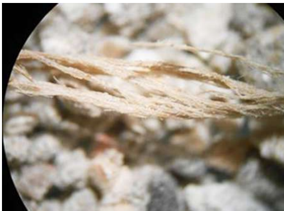
10. რომანცემენტის ნაღესობის შემავსებელი ნაძვის და ნახშირის მარცვლების ჩანართებით Fillers of the Roman cement with granules of fibers and grains of charcoal
